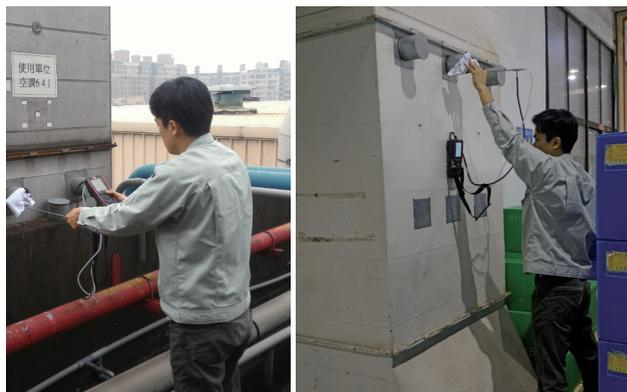
定期進行廢氣排放自主檢測，檢測廢氣 VOCs 排放數值，監控空污防制設備效能。
