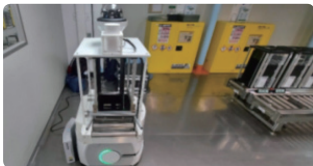
自動搬運機影像安巡系統
